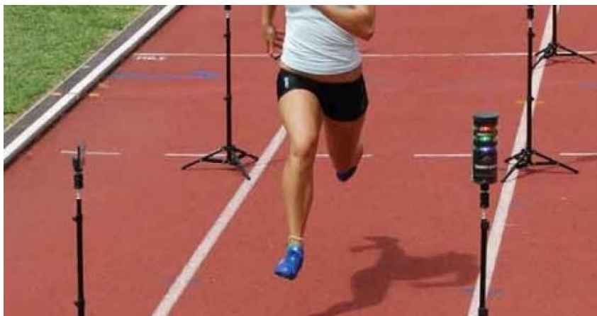
Slika 2. Prolazak kroz foto-ćelije u sprintu
