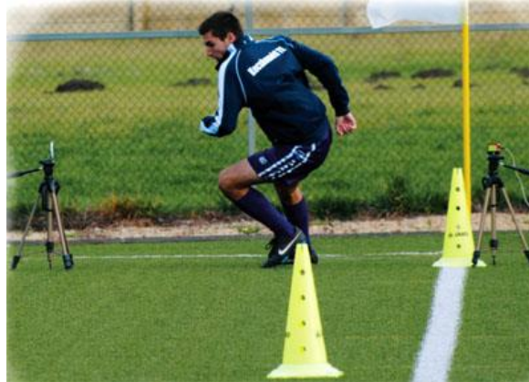
Slika 9.- svetlosne kapije sa sensorima koje mere brzinu trčanja u stotom delu sekunde.
